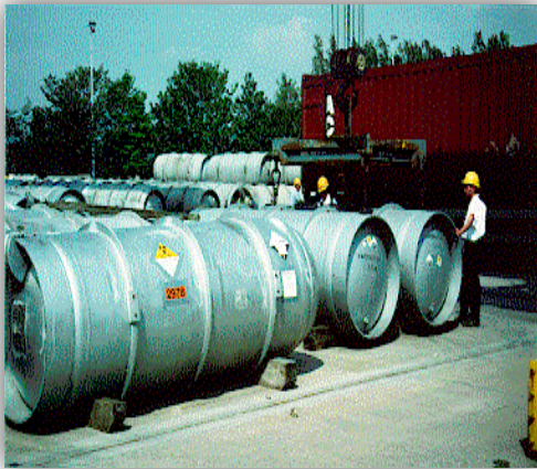
Parc d'entreposage de cylindres d'UF 6 (sans surcoque)
