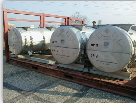
Cylindres d'UF 6 sur un châssis de transport
