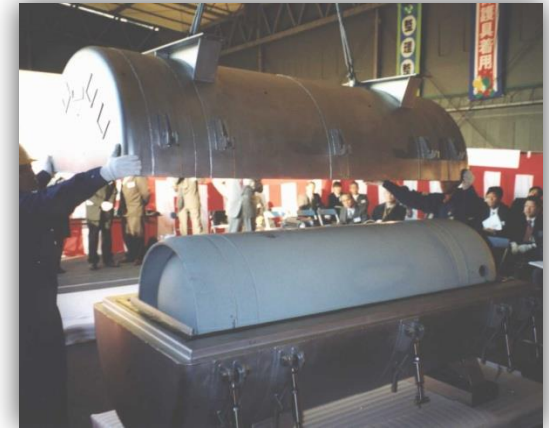
Cylindre d'UF 6 entrant dans sa surcoque de protection thermique
