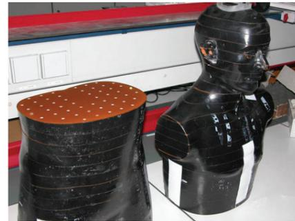
Des dosimètres adaptés au type de rayonnement sont placés en surface et à l'intérieur de mannequins.
