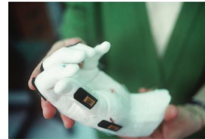
Des dosimètres adaptés sont placés en surface et à l'intérieur de moulages pour reconstituer la dose reçue.
