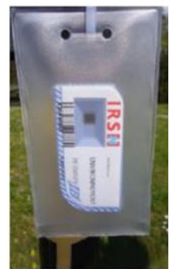
Figure 13 : Points d'implantation des dosimètres passifs (RPL) en 2021 et photographie d'un dosimètre RPL
