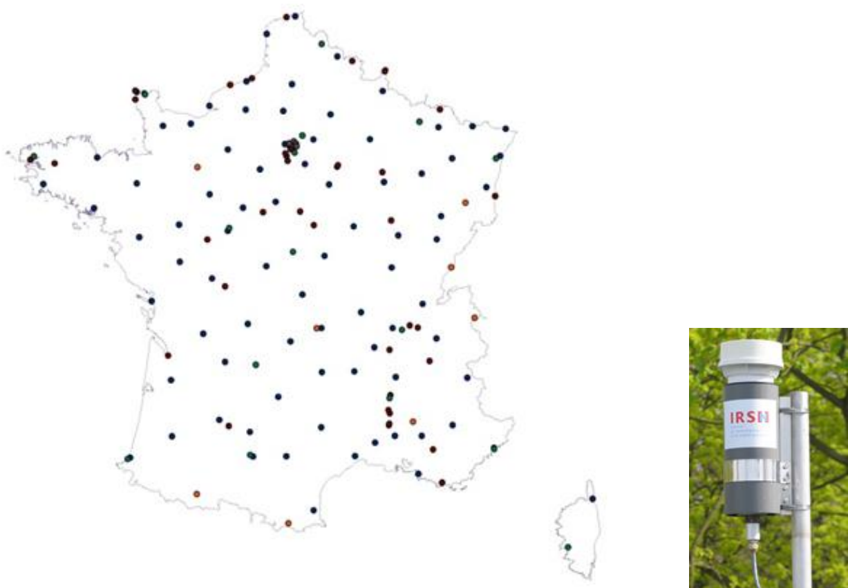
Figure 8 : Points d'implantation des balises du réseau Téléray en 2009 et photographie d'une balise
