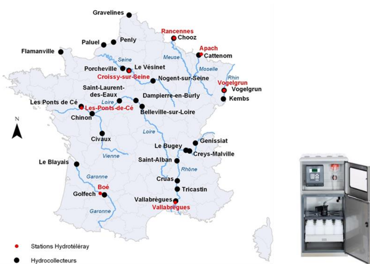
Figure 14 : Points d'implantation des hydrocollecteurs (points noirs) de l'IRSN en 2009 et photographie d'un hydrocollecteur
