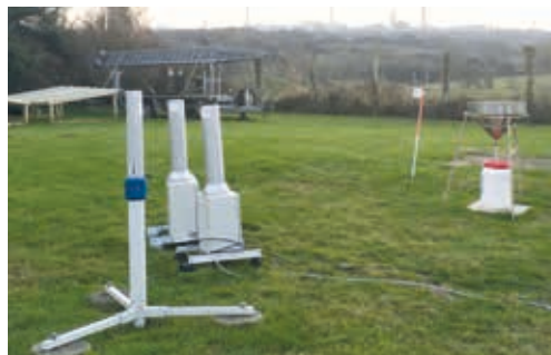
Balise Téléray (1 er plan à gauche), à la station d'Omonville-la-Petite
