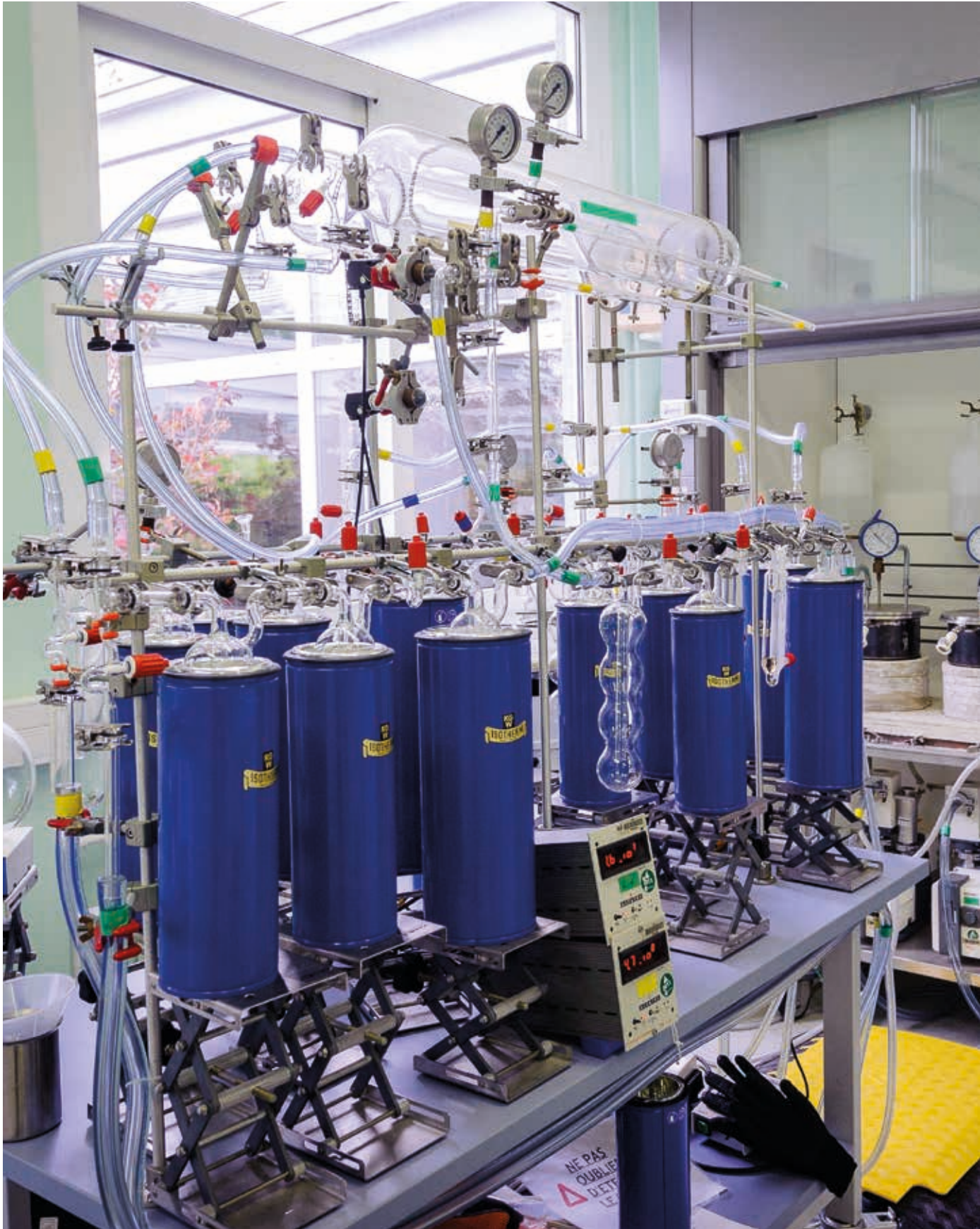
Banc de mesure du carbone-14 par synthèse du benzène
