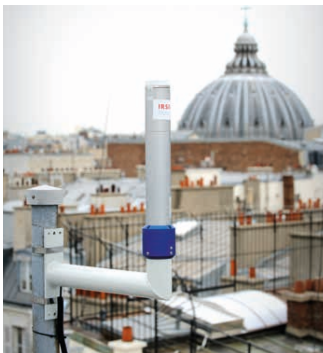
FIGURE 1 / SONDE DE MESURE EN CONTINU DU DÉBIT DE DOSE GAMMA AMBIANT DU RÉSEAU TÉLÉRAY DE L'IRSN (photo 1A) ET DOSIMÈTRE RPL INSTALLÉ SUR LE SITE DE CADARACHE (photo 1B)
