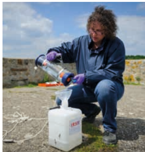
FIGURE 9 / ÉCHANTILLONNAGE PONCTUEL D'EAU À L'AIDE D'UN PRÉLEVEUR HORIZONTAL KEMMERER
