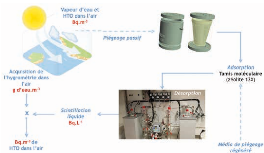
FIGURE A / GÉOMÉTRIE DU PRÉLEVEUR PASSIF TRITIUM (Brevet IRSN n : W02014037461), IMPLANTATION DANS L'ENVIRONNEMENT ET PRINCIPALES CARACTÉRISTIQUES
