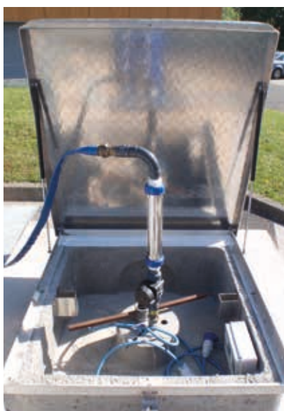
Piezomètre de prélèvement d'eau de nappe phréatique
