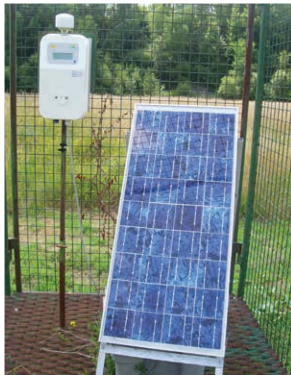
FIGURE 4 / BARBOTEURS POUR LE PRÉLÈVEMENT DU TRITIUM OU DU ^{14}C ATMOSPHÉRIQUE
