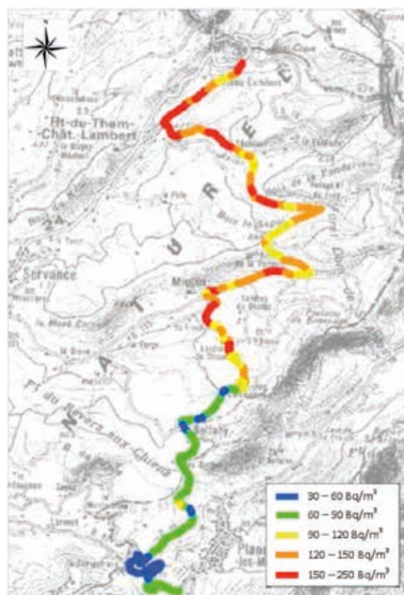
FIGURE 7 / ACTIVITÉ VOLUMIQUE EN RADON-222 MESURÉE AU COURS D'UNE NUIT (entre 22h et minuit) AU MOYEN D'UN LABORATOIRE MOBILE (mesure à 2 mètres du sol)
