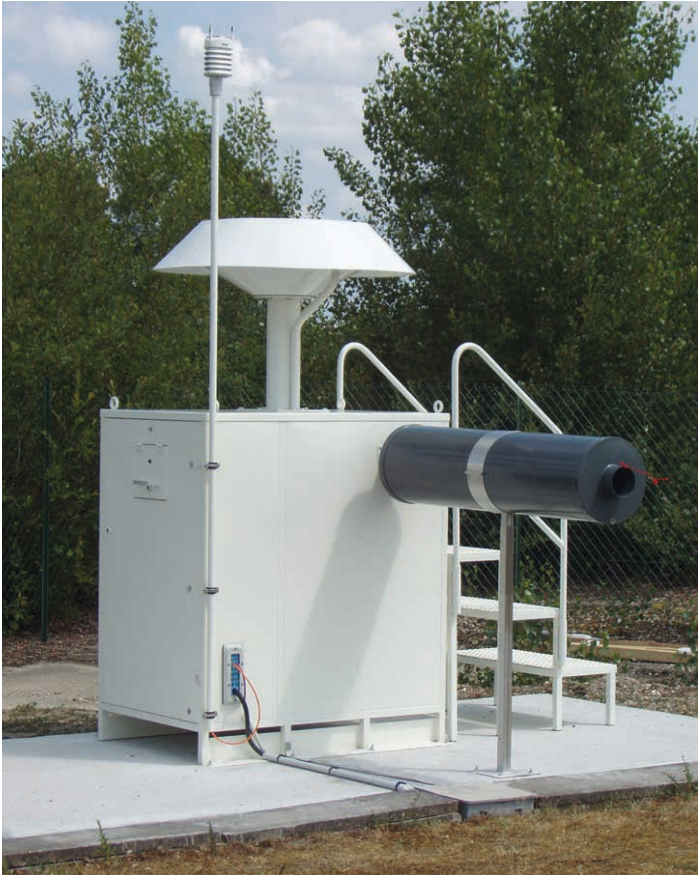
Station de prélèvement d'aérosols atmosphériques OPERA-AIR TGD 700 m 3 /h
