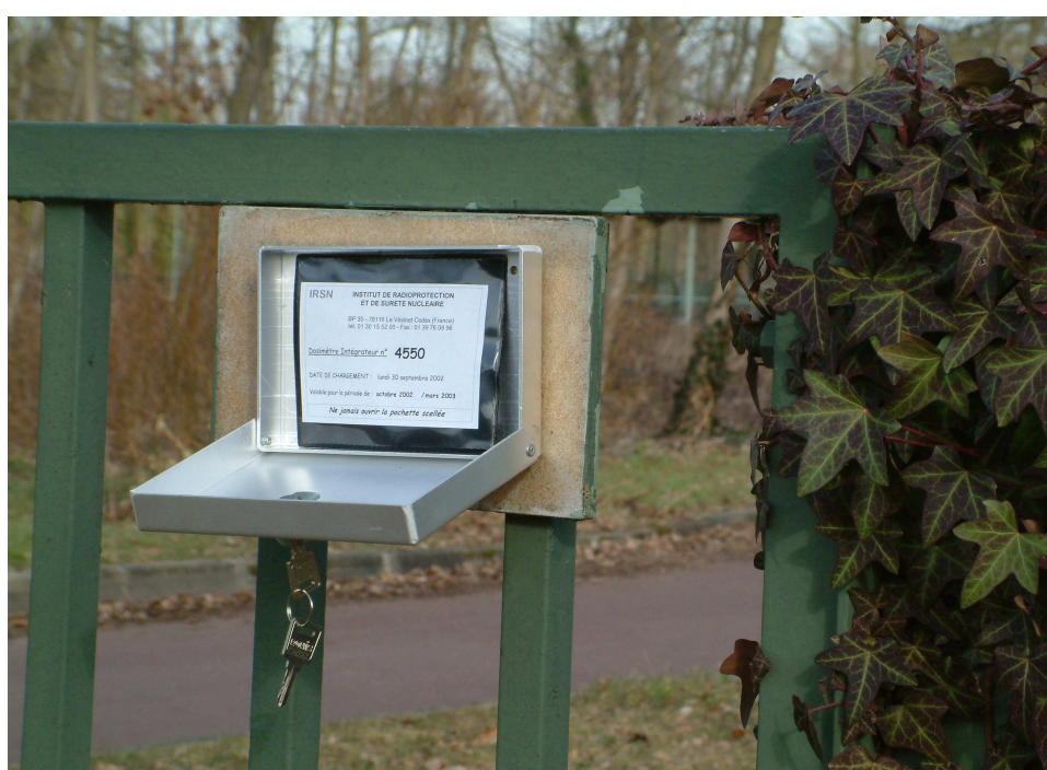
Figure 23 : Dosimètre thermoluminescent et son boîtier de protection
