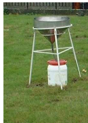
Figure 36 : Collecteur d'eau de pluie
