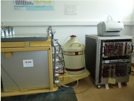
Spectromètre \gamma GeHP matini mania nia ore ta ati hia e te veto cosmique ( ^{137}\text{Cs} , ^{60}\text{Co} ...)
