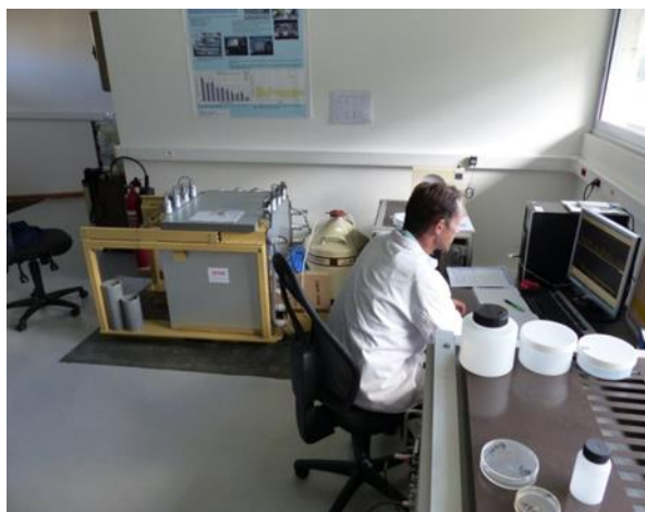
Hoho'a 6 : Spectrométre \gamma GeHP matini mania nia ore ta ati hia e te veto cosmique ( ^{137}\text{Cs} , ^{60}\text{Co} ...)
