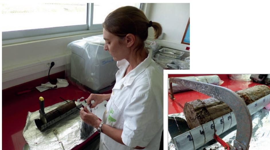
Figure 15 - Découpe des différents horizons d'un échantillon de sol de Raivavae.
