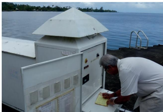
Figure 9 - Station de prélèvement d'aérosols à Vairao.
