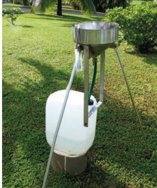
**Figure 8.** Collecteur d'eau de pluie à Vairao (presqu'île de Tahiti). Les analyses de l'eau de pluie, de fréquence mensuelle jusqu'en 2009, sont faites semestriellement depuis 2010 tout en conservant la continuité du prélèvement mais en réduisant la surface de collecte.
