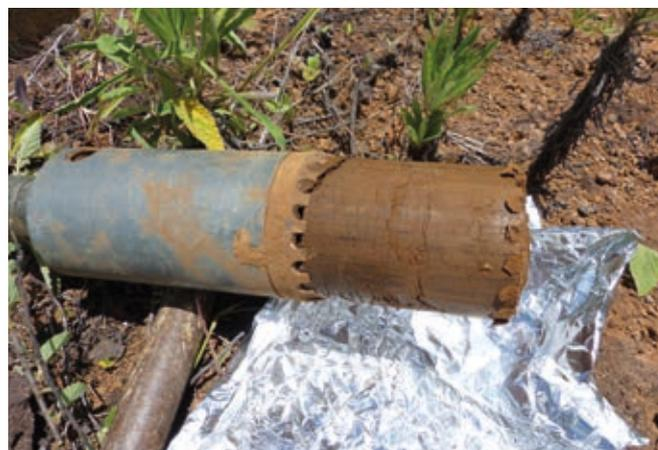
**Figure 11.** Trois prélèvements, sauf pour les sites Nh3 et Nh4 (cf. texte), sont réalisés pour chacun des sites de Nuku Hiva et de Hiva Oa à l'aide d'un carottier de 15 cm de longueur et de 8 cm de diamètre.
