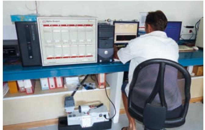
Figure 5. Spectromètre alpha ( $^{238}\text{Pu}$  et  $^{239+240}\text{Pu}$ ).
