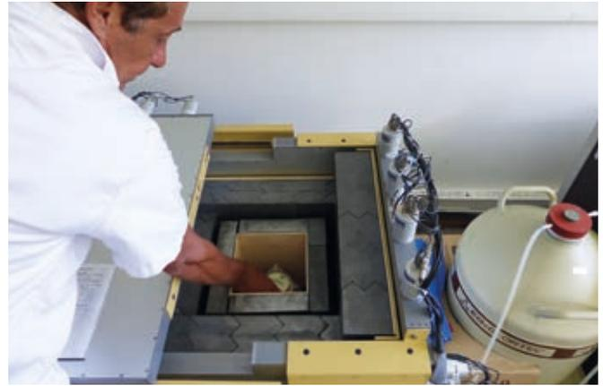
Figure 4. Spectromètre  $\gamma$  Ge HP bas bruit de fond équipé d'un veto cosmique ( $^{137}\text{Cs}$ ,  $^{60}\text{Co}$ ...).
