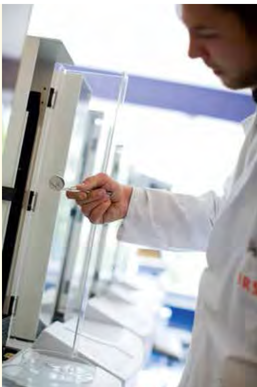
Figure II.48 - Chargement d'un échantillon préparé dans un compteur proportionnel bêta.
