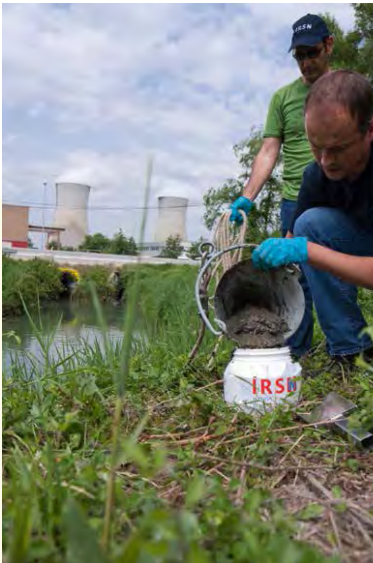
■ Figure II.45 - Prélèvement de sédiments (technique du cône de Berthois) effectué dans la Caffière en aval du site nucléaire du Tricastin.
