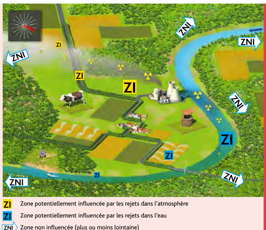
■ Figure III.2 - Schéma des zones potentiellement influencées (ZI) ou non (ZNI) par les rejets d'une installation. Exemple d'installation ayant des rejets atmosphériques et des rejets liquides dans un fleuve.
