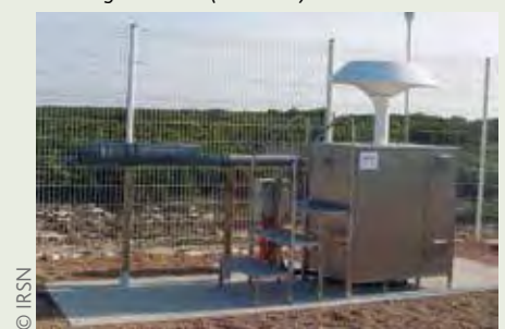
Figure I.15 - Nouveau dispositif de prélèvement moyen débit (80 m 3 /h) de l'IRSN.
