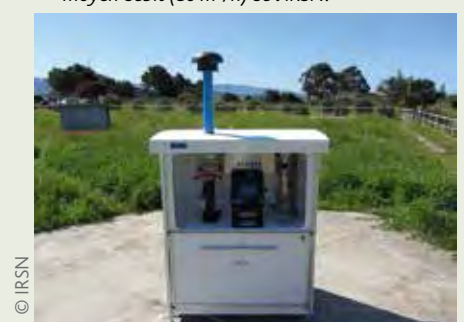
Figure I.15 - Nouveau dispositif de prélèvement moyen débit (80 m 3 /h) de l'IRSN.
