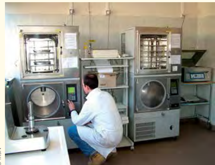
■ Figure II.31 - Lyophilisation des échantillons préalablement aux protocoles de mesurage du carbone 14.
