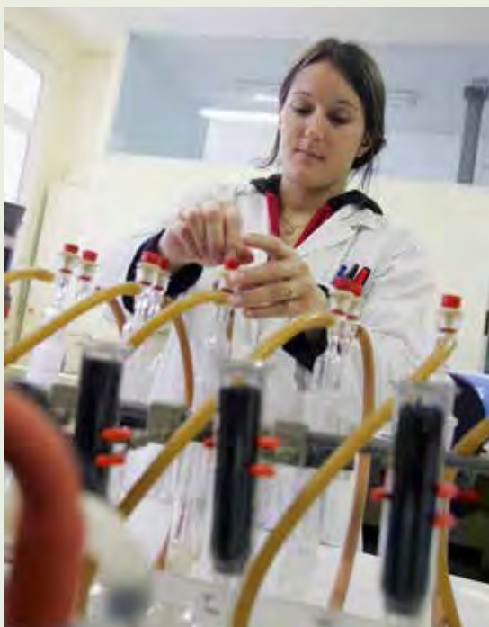
Figure I.25 - Analyse du radium 226 par la méthode d'émanométrie.
