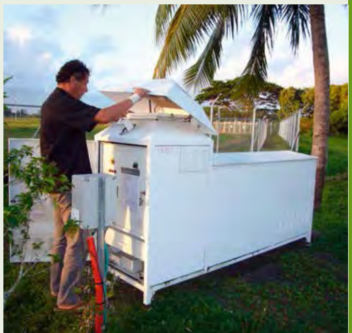
■ Figure I.21 - Station Opera-Air (très grand débit) de l'IRSN sur l'île de Tahiti.
