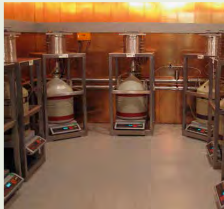
Figure I.26 - Salle de spectrométrie gamma à bas bruit de fond de l'IRSN.
