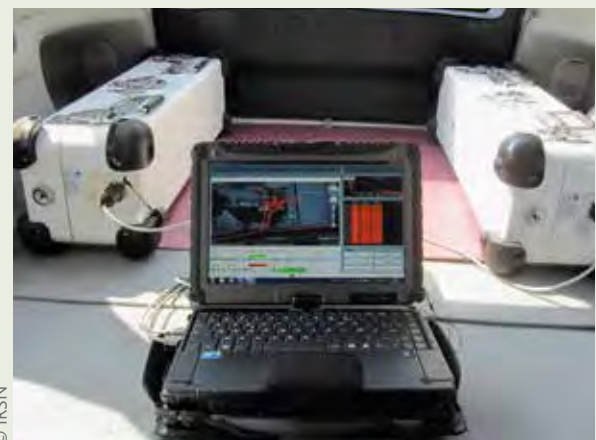
Figure 1.29 - Système Ulysse, muni de deux détecteurs NaI de 2 litres : réalisation d'une cartographie de contamination surfacique du site IRSN du Vésinet.
