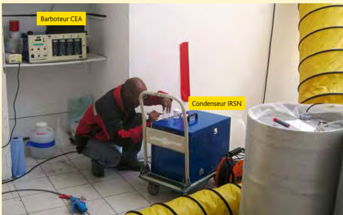
■ Figure II.27 - Prélèvements de vapeur d'eau de l'air dans le local contaminé avec un barboteur (équipement installé par le CEA) et un condenseur à tritium (équipement IRSN).
