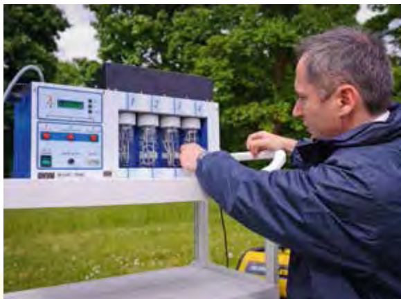
Figure II.19 - Photo d'un préleveur par barbotage permettant de quantifier le tritium dans l'atmosphère.
