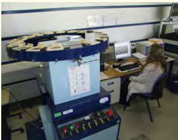
Figure II.58 - Spectromètre gamma surmonté d'un passeur d'échantillons.
