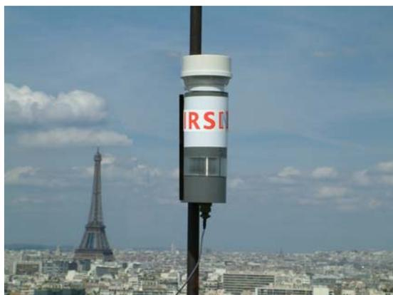
permettant de mesurer le débit de dose gamma ambiant. Une carte électronique et un modem associé permettent le calcul du taux de comptage et le transfert des données vers le PC centralisateur situé sur le site IRSN du Vésinet.
