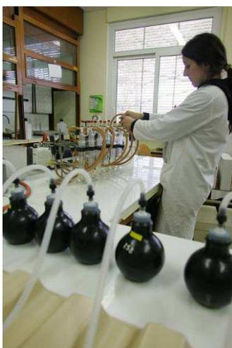
Figure 8 : Traitement en vue de la mesure du radium 226 dans les eaux
