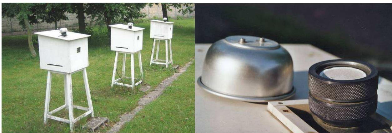
*Figure 75 : Photo des stations de prélèvement d'aérosols du site du Vésinet (IRSN) et détail de la tête de prélèvement et du dispositif porte-filtre*
