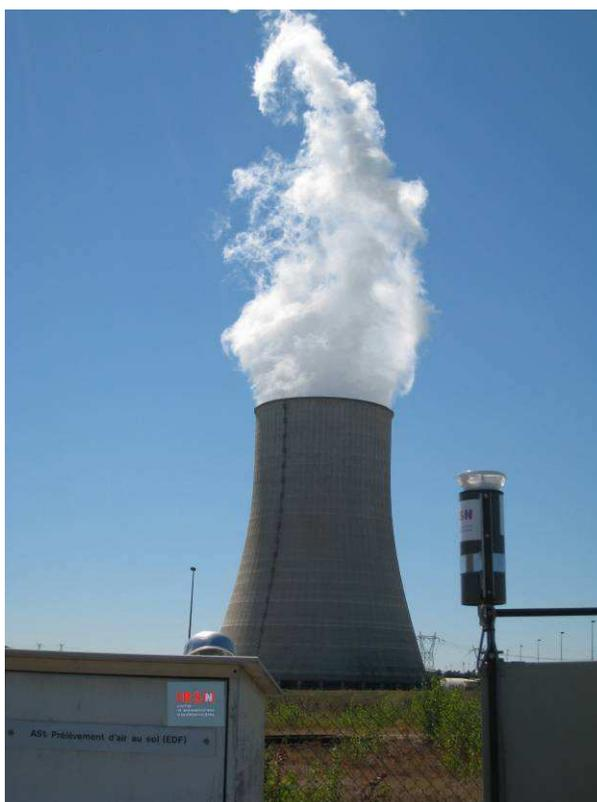
Figure 70 : Photo d'une sonde Téléray (détecteur Geiger Müller)
