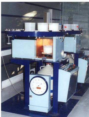
Figure 10 : Mesure d'échantillons de lait sur une chaîne de spectrométrie gamma
