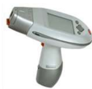
Figure 1.2 - Appareil de marque NITON-XLp 300 permettant l'analyse par fluorescence X pour la recherche de plomb
