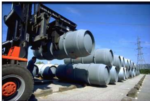
Figure 2.10 - Manutention d'un « cylindre » d'UF 6 sur le site du Tricastin
