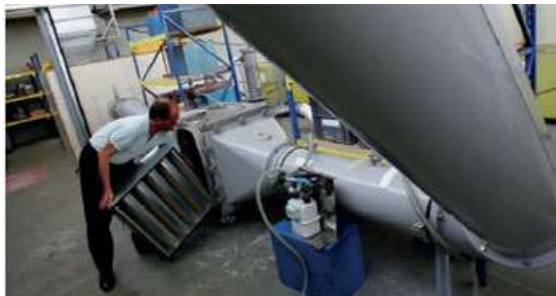
Banc d'essais de filtres THE (BORA) à l'IRSN - Fontenay-aux-Roses.
