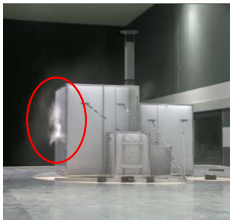
Figure 4.6 - Expérience en soufflerie montrant la dispersion d'un fumigène malgré la présence d'une ventilation dans la maquette
