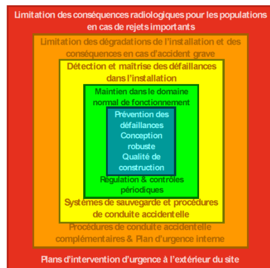
Figure 1.7 - Les 5 niveaux associés au principe de « défense en profondeur » en France
