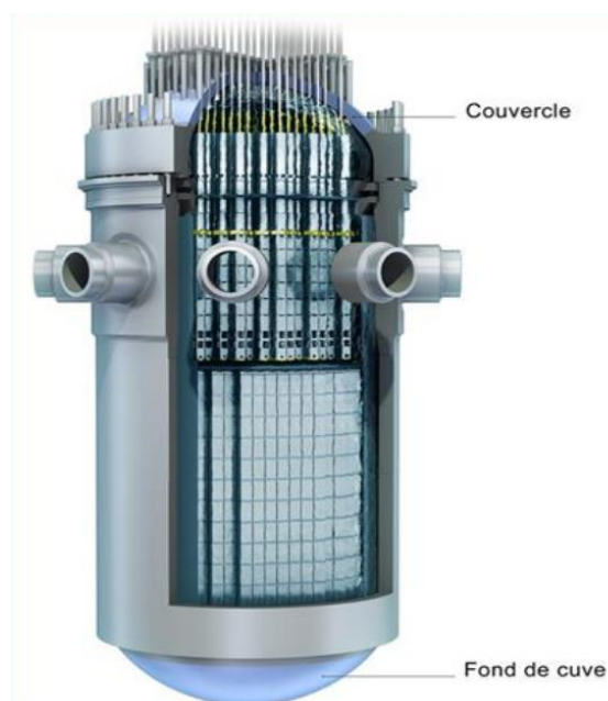
Figure 6 : Schéma de la cuve de l'EPR
