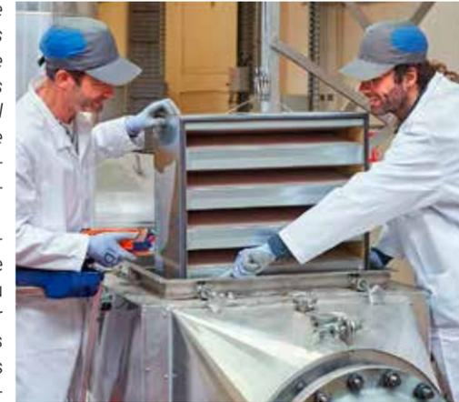
Soleiman Bourrous (à droite) et un membre de son équipe installent un filtre THE dans un conduit de ventilation lors d'un essai.
