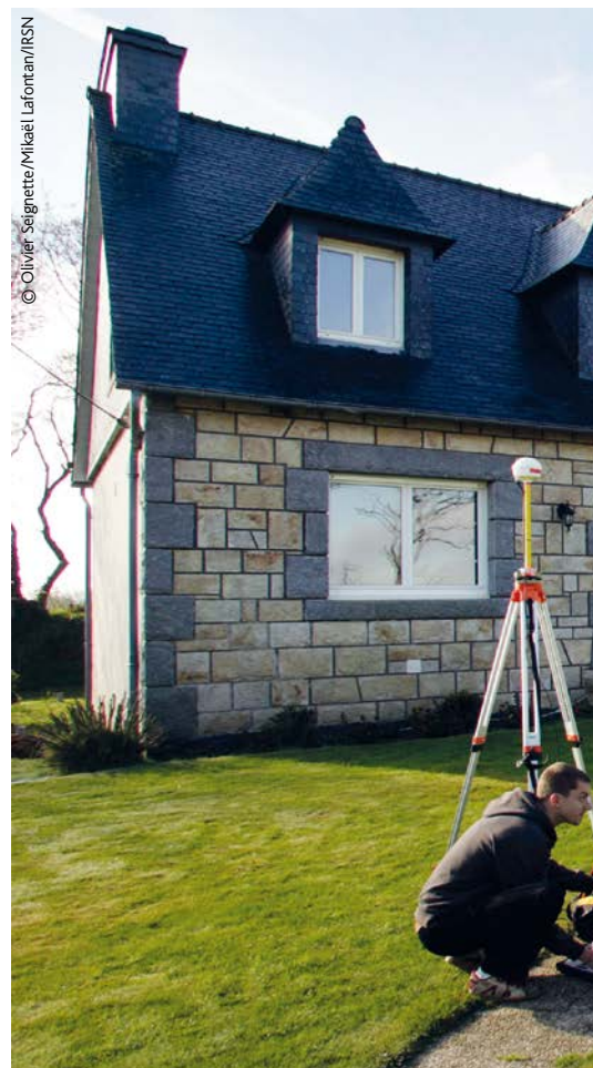
L'expert utilise une sonde bas flux avec un radiamètre pour mesurer la radioactivité.
