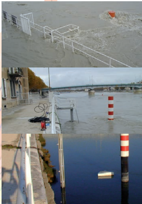
Trois vues de la Station observatoire du Rhône à Arles (Sora), en période de crue en décembre 2003 ( 10\,050\text{ m}^3\text{ s}^{-1} ) et en novembre 2002 ( 8\,010\text{ m}^3\text{ s}^{-1} ) et en période de calme hydrologique. Les prélèvements d'eau sont réalisés à 50 cm sous la surface de l'eau, quel que soit le débit du fleuve, grâce à une pompe immergée et un flotteur (triangle blanc juste en amont de la bouée de signalisation rouge et blanche) relié à la station par un bras articulé. La station relève en continu 3\text{ m}^3 d'eau par heure afin d'alimenter un circuit ouvert d'alimentation et les différents points des collectes des échantillons.
