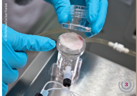
Mise en place d'un explant de peau de cochon sur une cellule de Franz pour tester la nano-émulsion de calixarène. L'émulsion reste efficace jusqu'à un rapport d'une mole de calixarènes pour 32 moles d'uranium, avec une concentration idéale de calixarène dans la nanoémulsion de 4 mg/g.
