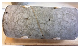
Éprouvettes cylindriques de béton (diam. : 11 cm, long. : 22 cm). En haut, béton sain. En bas, béton atteint de RSI.
