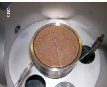
Brûleur à flamme plate utilisé pour l'étude des réactions de l'iode avec l'oxygène et l'hydrogène (thèse de Y. Délicat).
