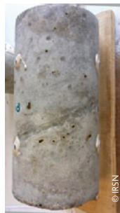
Éprouvettes cylindriques de béton (diam. : 11 cm, long. : 22 cm). En haut, béton sain. En bas, béton atteint de RSI.
