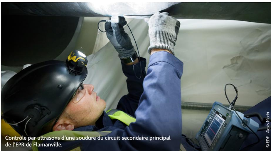
Contrôle par ultrasons d'une soudure du circuit secondaire principal de l'EPR de Flamanville.
