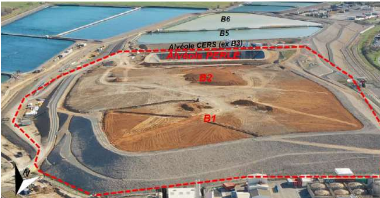
Figure 1 – Vue aérienne de la partie INB ECRIN du site de Malvési en février 2020, en phase de vidange des bassins B5 et B6 pour constituer les alvéoles PERLE et CERS.
