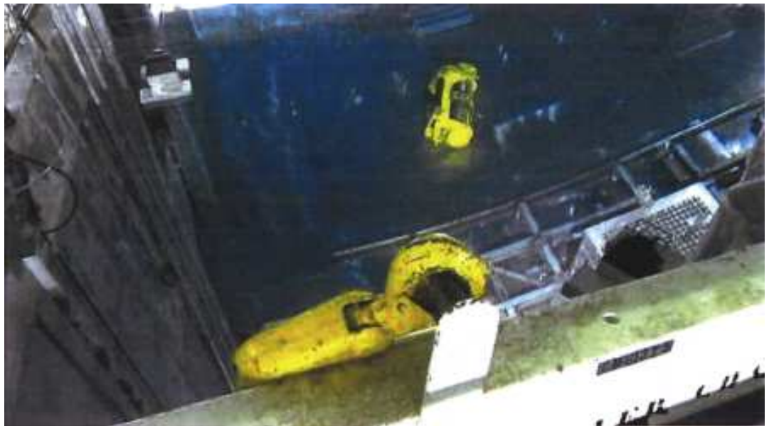
Localisation du palan dans le hall bassin après sa chute
