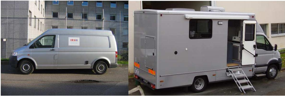
Figure 20 - Véhicule léger d'intervention (à gauche) et laboratoire mobile (à droite) de mesure de la radioactivité d'échantillons environnementaux (IRSN).
