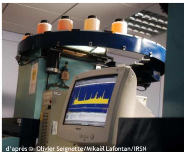
Figure 2 - Mesure de la radioactivité au sein d'échantillons urinaires par spectrométrie \gamma dans le cadre d'analyses radiotoxiques
