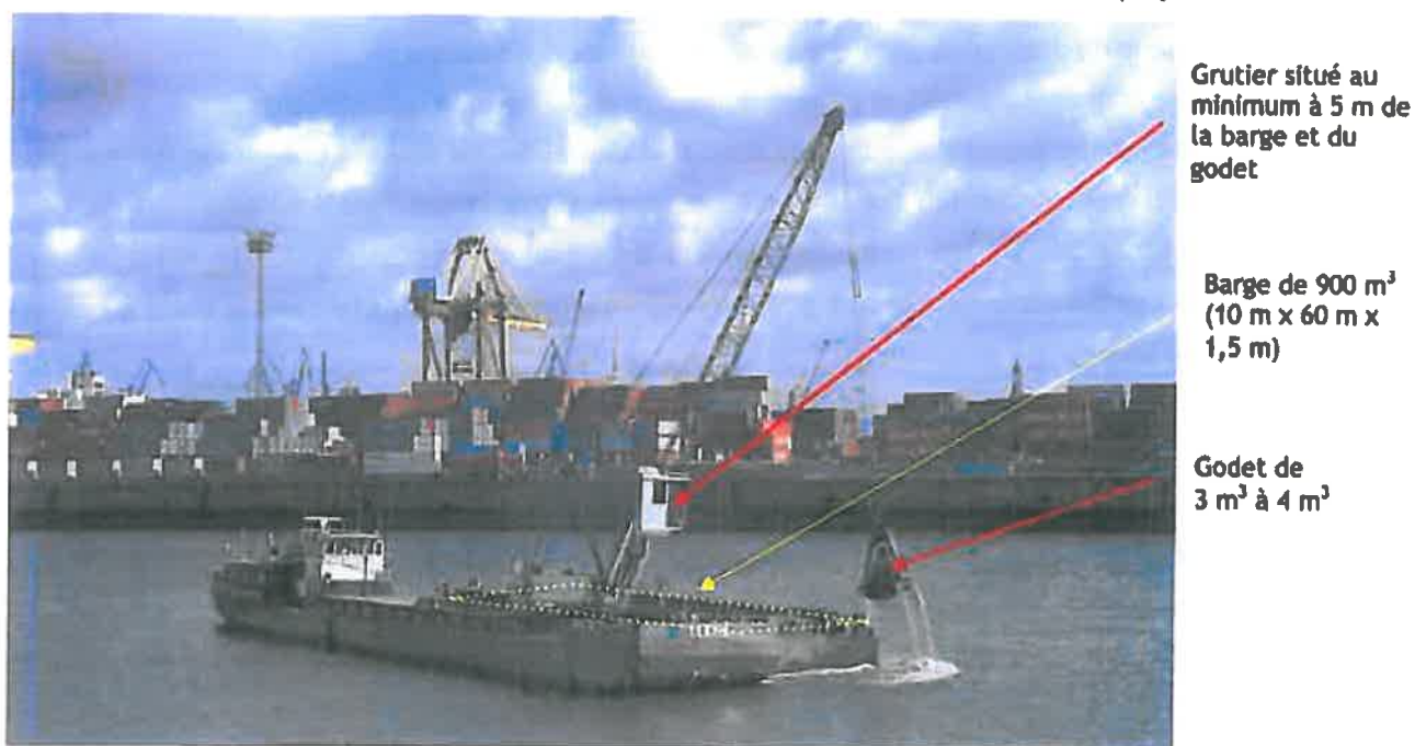
Figure 3. Illustration d'un chaland et conditions d'exposition associées
